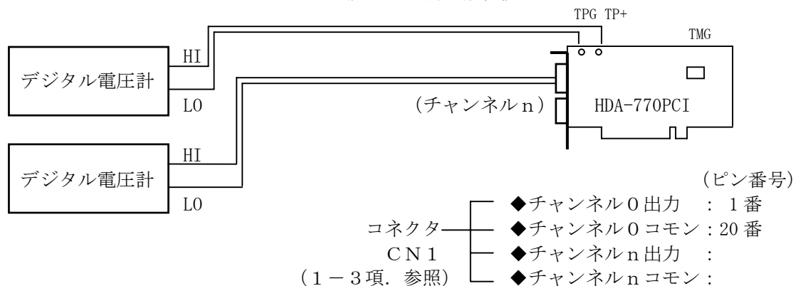
図7-3. 再調整用の測定機接続
